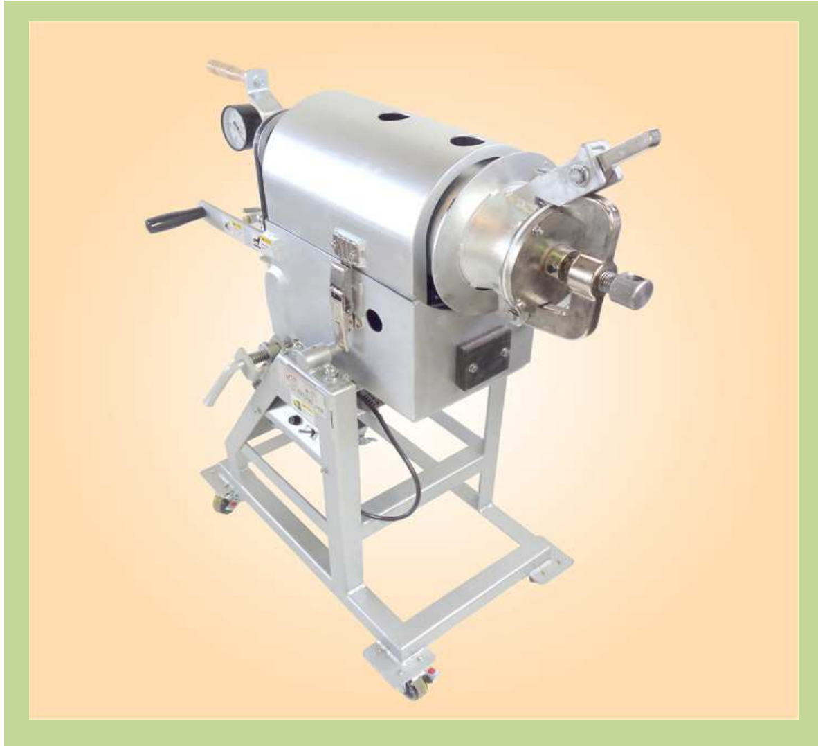
圧力式焼栗機(3kg加工用)
