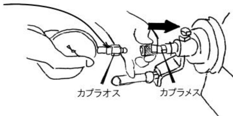
カプラメスのギザギザ部を指で矢印方向に押すと圧力計を取り外せます。
